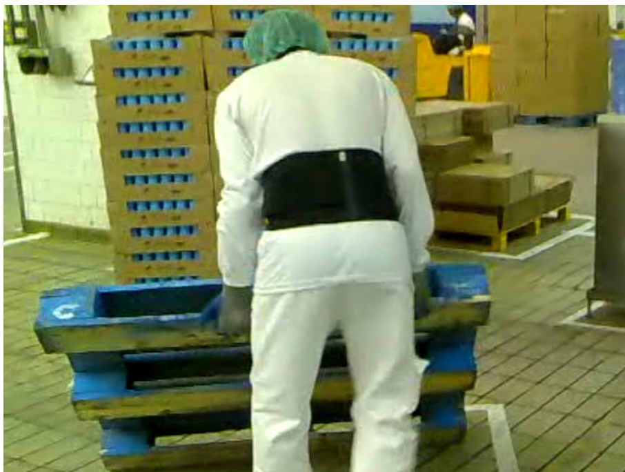
Figura 14 – Colocação do estrado para início da paletização.
