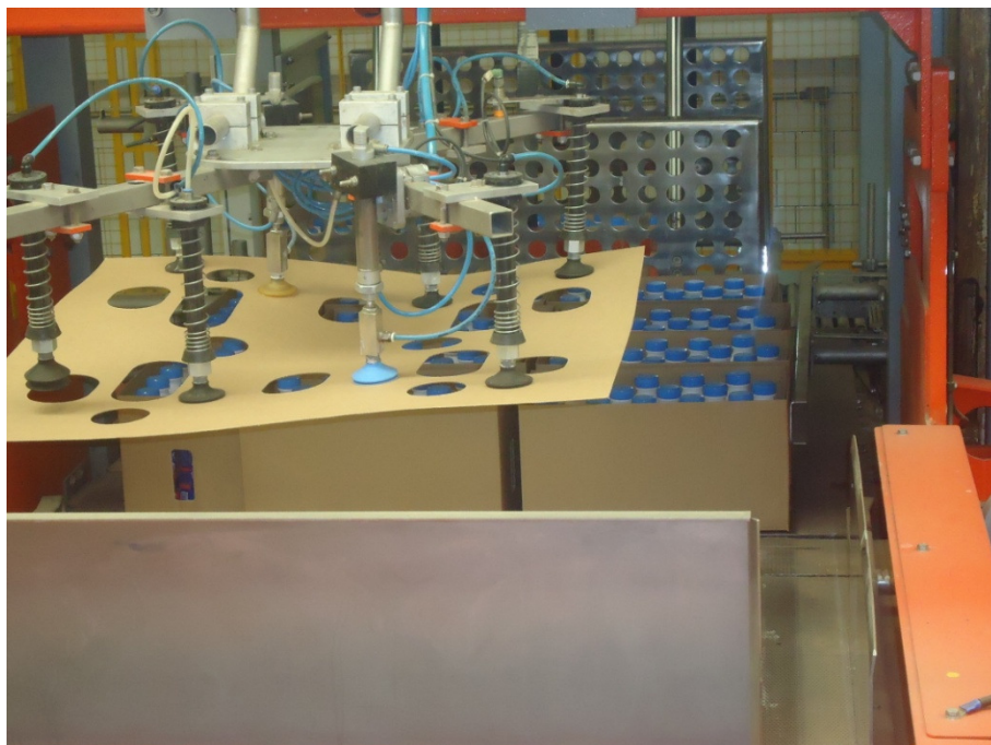
Figura 7 – Colocação do reforço de estrutura.
