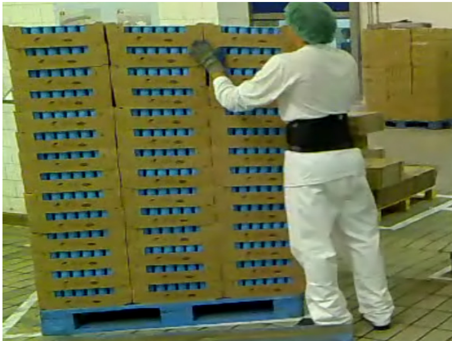
Figura 13 – Colocação final da caixa, na parte mais alta.
