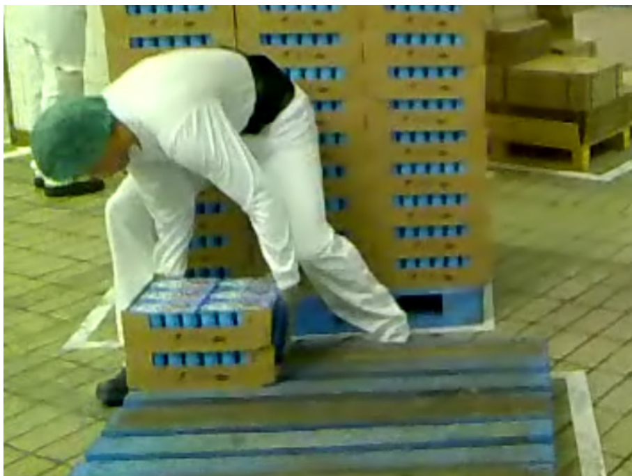
Figura 12 – Colocação inicial da caixa no estrado.
